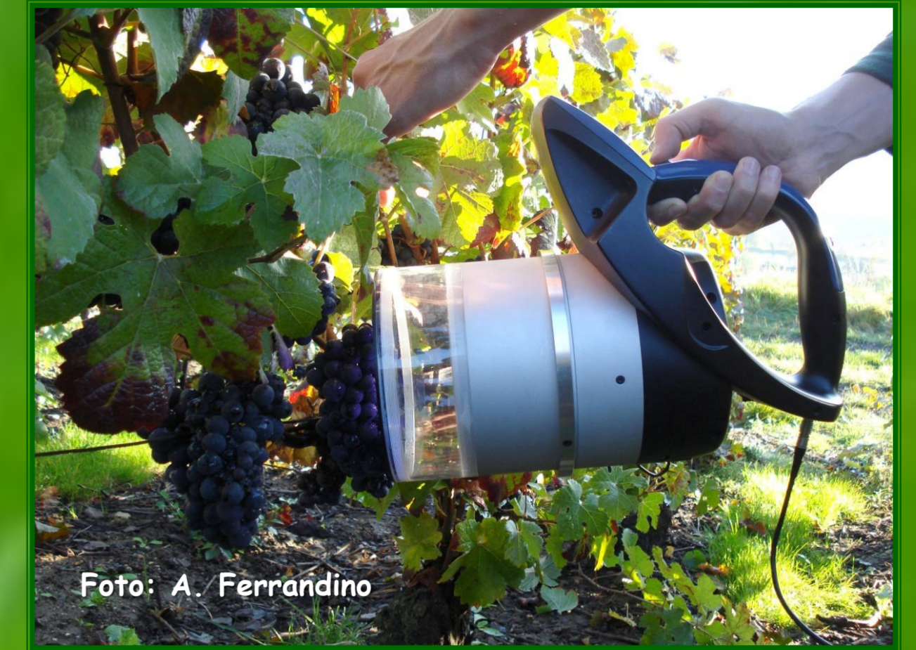
Fig.1 Misure non distruttive in vigneto tramite Multiplex®.
